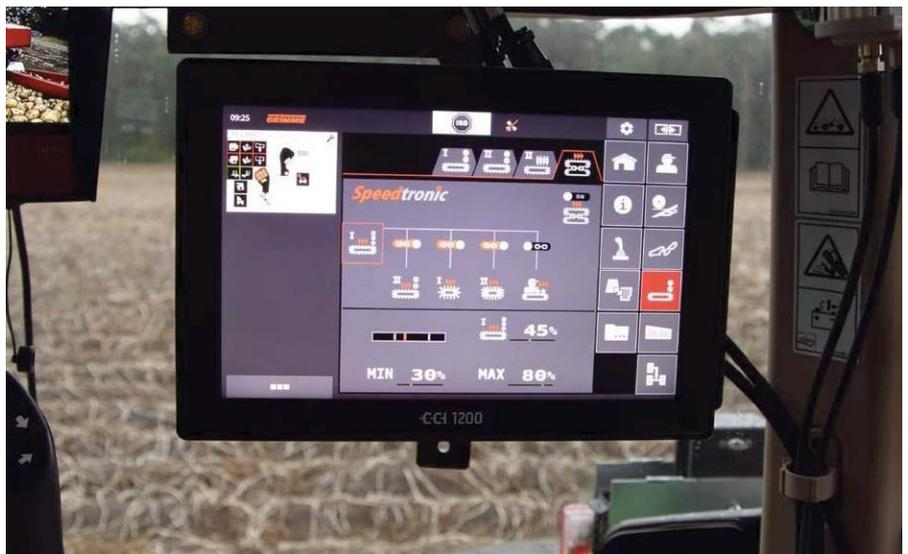
メモリーコントロールにより、ドライブとセパレーターを集中調整できます。速度、調整可能な角度、様々な収穫条件のパーセンテージ値などの設定を保存し、必要に応じてこれらをすぐに呼び出すことができます。
