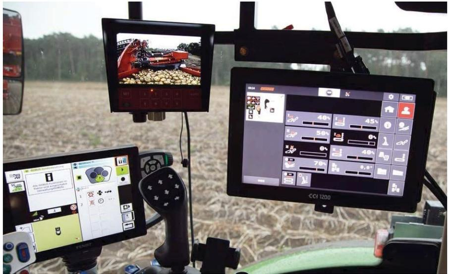
オプションのスピードトロニックは、収穫条件に合わせてセパレーターとピックアップテーブルの速度を自動的に調整いたします。これにより、作物保護が強化されると同時に、エリア出力が増加し、ドライバーの負担が軽減されます。
